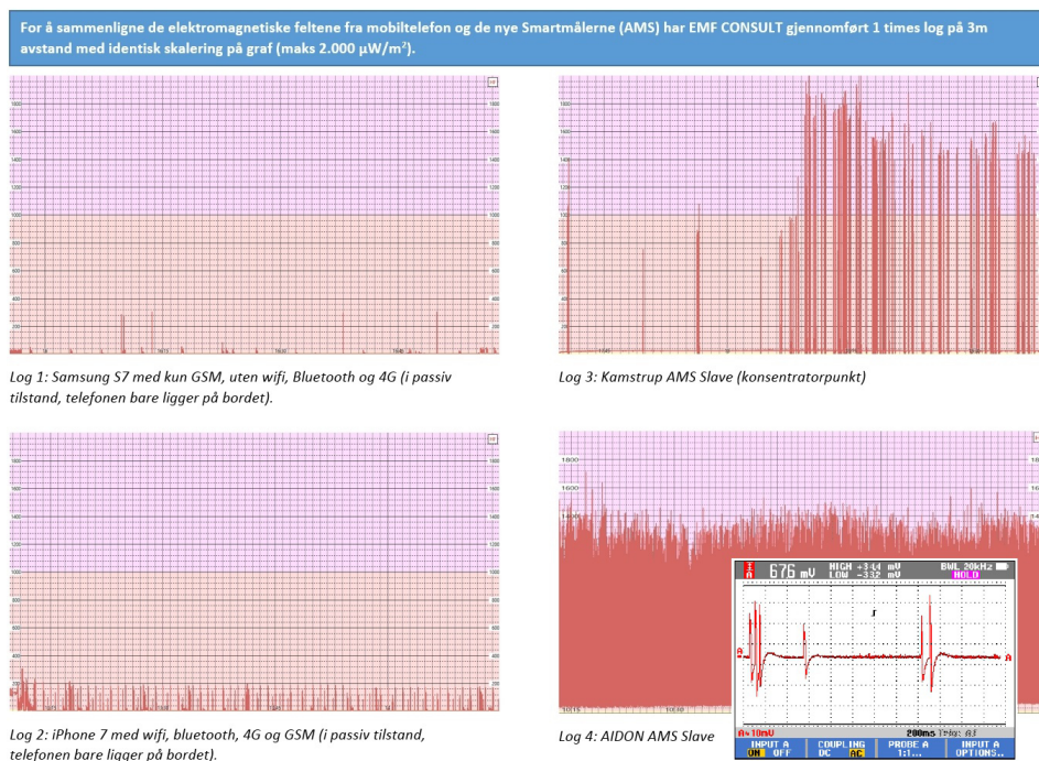
Figur 25: Sterke pulser fra AMS-målere (til høyre) i forhold til mobiler (til venstre), målt over 3 timer. Innfelt detalj fra en AMS-måler med pulser på ca 12 millisekunders lengde. Altså vil gjennomsnittlig signalstyrke fra AMS-målerne bli svært lav uansett pulsstyrken (målinger: EMF-Consult AS 2018).
