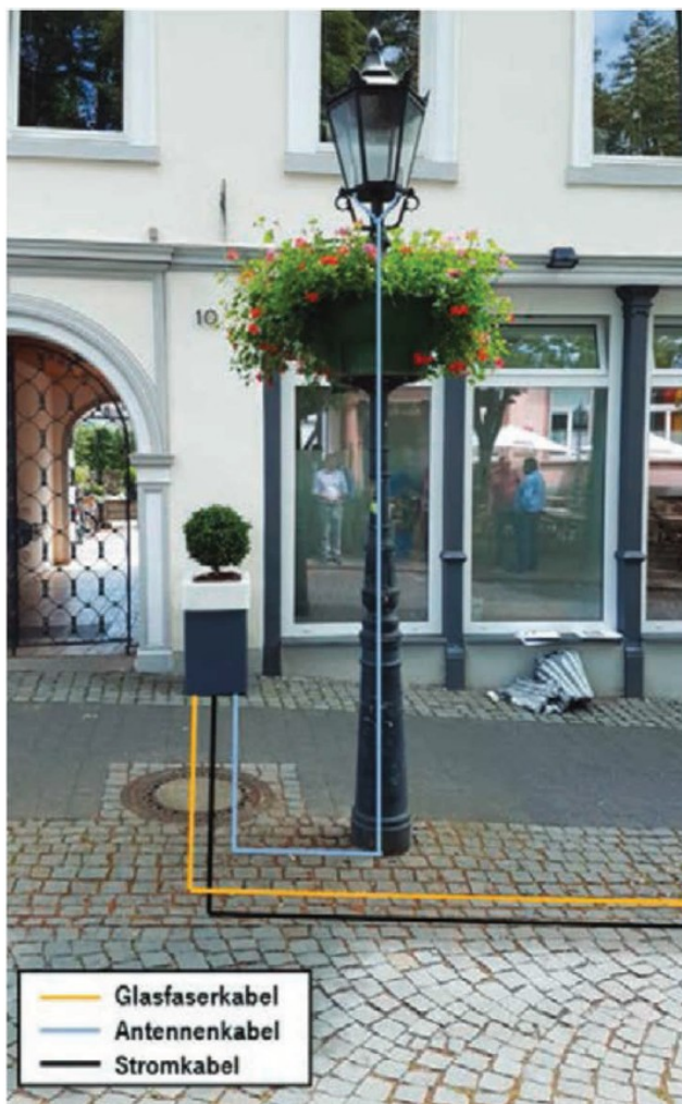
Bilde 4: Liten celle-installasjon, skjematisk framstilt (Kilde: Deutsche Telekom/Raycap [6])
