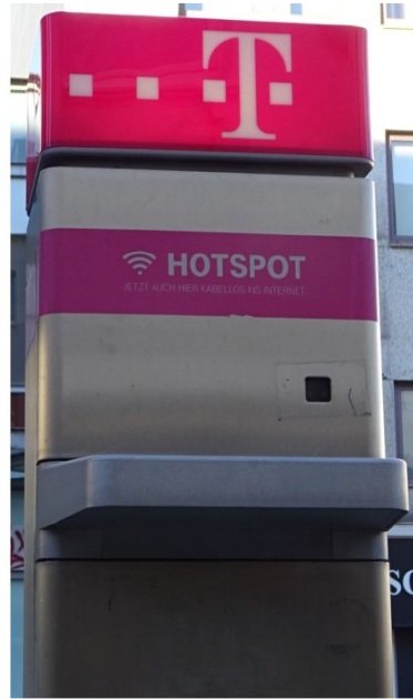
Bilde 1: Mikroceller for telekom med LTE-mobilnett («hotspot») i et fotgjengerområde. Slike har vært vanlige en god stund.
