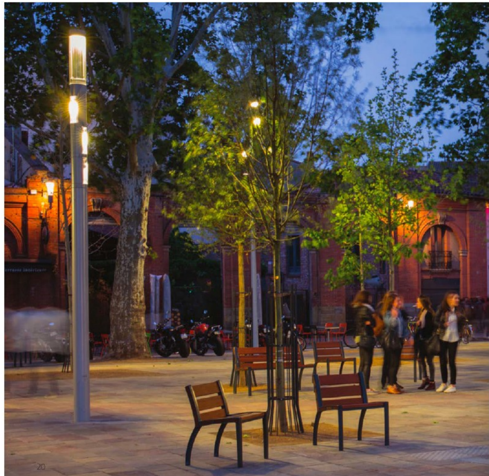
Bilde 7: Til venstre: Lyssøylen «Shuffle» og sideskap med plass for installasjon av ganske mye systemteknikk for små celler. Til høyre: lyssøylen «Shuffle» med systemteknikk og antenne integrert i selve stolpen [7]
