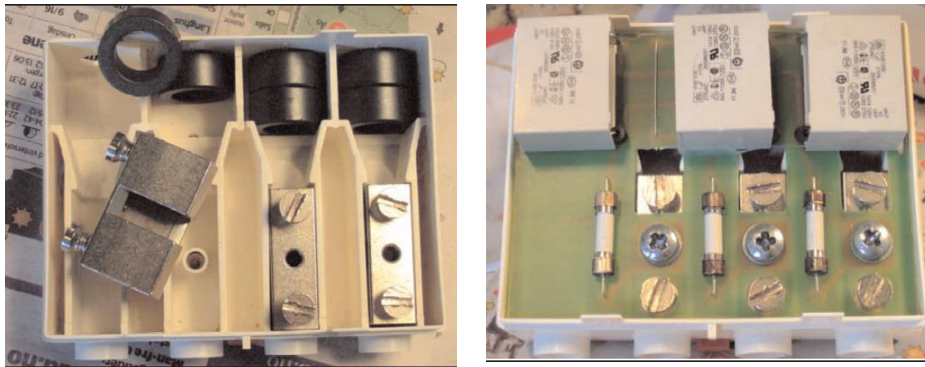
Figur 62: Nobøfilteret, ferrittdelen til venstre og kondensator- og sikringsdelen til høyre.
