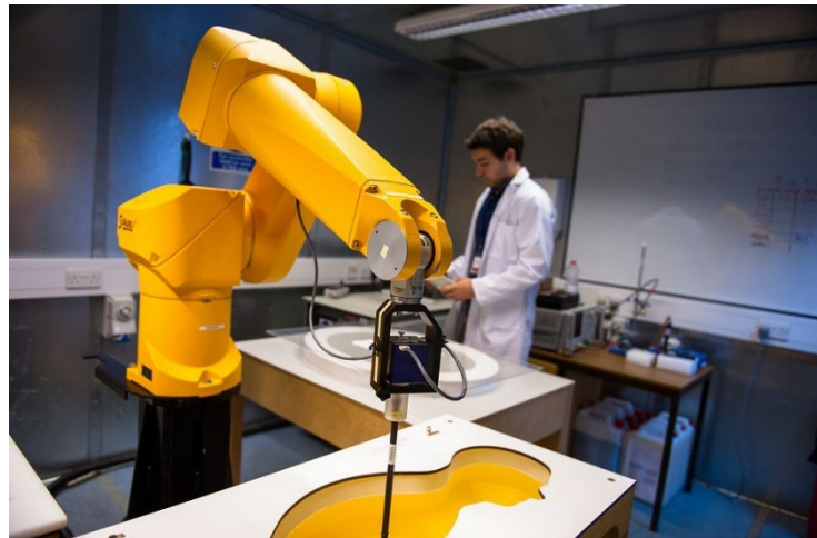
Fantommodell for måling av oppvarming, (Foto-UL Consumer Technology) Illustrasjon lagt inn av EF.
