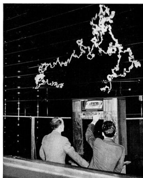
Hos General Electric 1940: FM-signalet tas inn klart tross i kunstig skapt lyn på 1 million Volt. (Wikipedia: "Frequency modulation")
