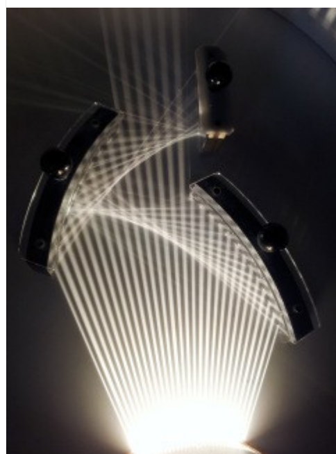
Reflekser i hodeskallen gir konsentrasjonspunkter. Her en speilmodell. Strålekilden nederst. (Foto: E.F.)
