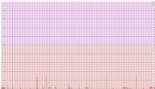
Log 1: Samsung S7 med kun GSM, uten wifi, Bluetooth og 4G (i passiv tilstand, telefonen bare ligger på bordet).
