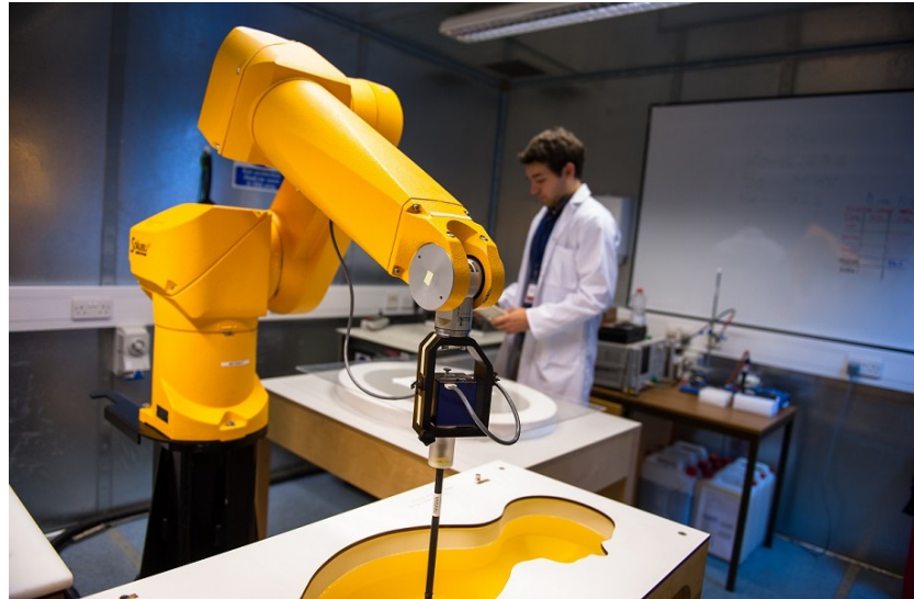
Testing av absorpsjonsevnen til kroppsvæv utført i forenklet modell av menneskekropp fylt med væske. (foto: UL Consumer Technology)
