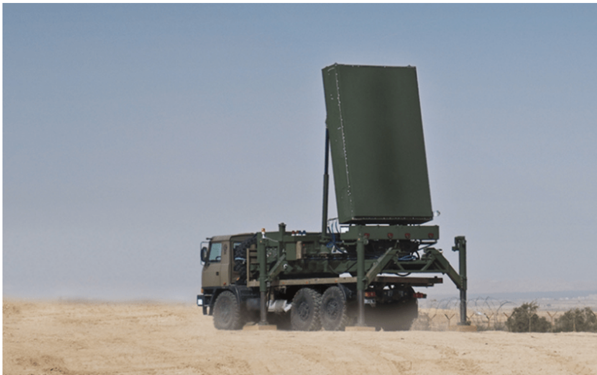
ELM-2084 Multi Mission Radar, en typisk radar-type brukt i Israel
